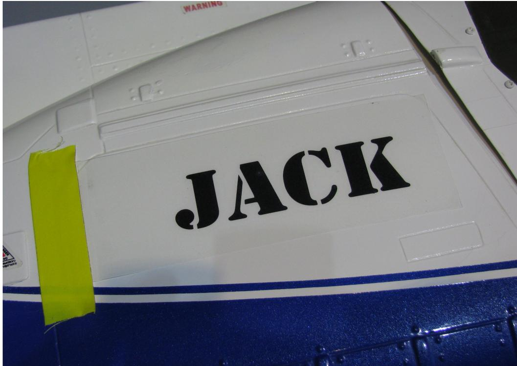
**Jetzt die Übertragungsfolie möglichst flach und diagonal von der Schrift abziehen:**
